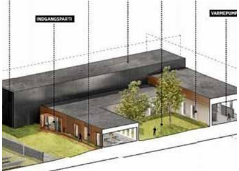
Sæby datacenter udnytter varmen fra køleprocessen ved hjælp af varmepumpe til fjernvarme
